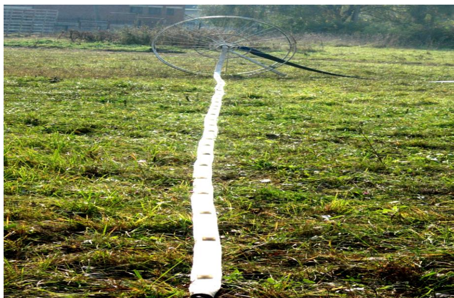
Рис. 1.57 - Общий вид унифицированной тележки комплекта ППК-25 с поливным шлейфом
