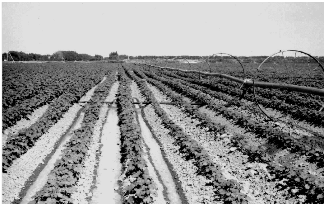
Рис. 1.51. - Общий вид крыла ТКП-90 с поливными шлейфами
